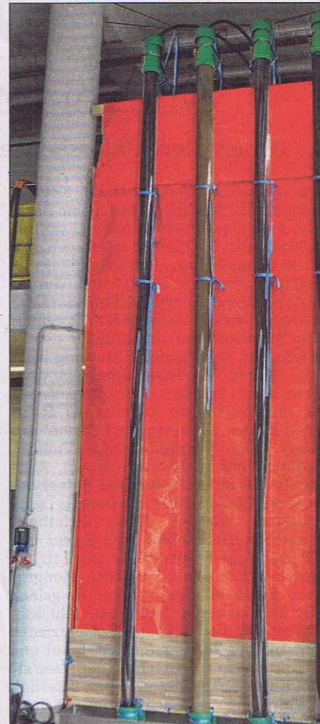
LULATSCHÉ: Mit sechs Meter hohen Aufbauten wird die Verfüllqualität von Erdwärmesonden analysiert. Foto: Julian Rolker
